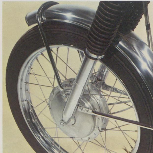
Diese Bremsen greifen sanft oder hart, ganz wie Sie es brauchen: großdimensionierte Leichtmetall-Vollnaben-Innenbackenbremsen mit 150-mm (!)-Trommeldurchmesser und eingegossenem Stahlmantel. Ihre Bewährungsprobe haben diese Bremsen im harten Geländesport bestanden.
