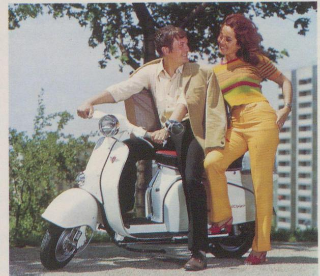
**Roller R 50/RS 50 Super:** Formschön und leistungsstark, R 50 mit 2,9 PS und 3 Gängen, handgeschaltet; RS 50 Super mit 4,6 PS und Viergang-Fußschaltung. Großzügiger Komfort, Allradfederung. R 50 Führerschein Kl. 5, RS 50 Super Führersch. Kl. 4, ab 16 Jahren. (Außerd. Kl. 1, 2 u. 3.)
