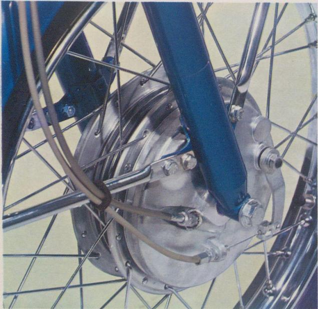
ZÜNDAPP baute als erster deutscher Hersteller Vollnaben-Innenbackenbremsen mit 150-mm-Trommeldurchmesser in seine 50-ccm-Motorräder ein. Die Qualität dieser Bremsen reicht weit über das übliche Maß hinaus. Innenbackenbremsen haben einen sehr hohen Wirkungsgrad und zeigen keinerlei Verzögerung bei plötzlicher Erwärmung. Für Ihre Sicherheit ist also optimal gesorgt.
