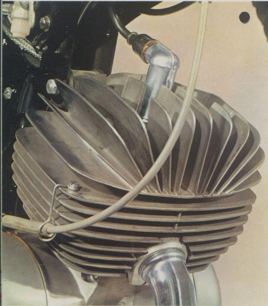
Das ist er, der neue, auf 6,25 PS gesteigerte ZÜNDAPP-50-ccm-Motor. Er ist sportlich getrimmt. Beschleunigt noch schneller, noch kraftvoller. Sein markantes Merkmal ist der wuchtige Fächerkopfzylinder mit verschleißfester, hartverchromter Lauffläche. Dieser Hochleistungs-Zylinder ist eine im harten Geländesport geborene, seit Jahren bewährte ZÜNDAPP-Spezialität.
