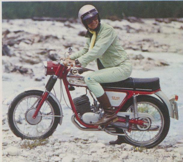
**KS 125 Sport:** Sportmotorrad par excellence. Die Summe aus Tausenden von Sporterefolgen. 15 PS, 125-ccm-Motor, hochwertiger, schwingengelagerter Doppelschleifenrahmen, sportlich erprobte Federung und Bremsen, 5-Gang-Getriebe. Führerschein Klasse 1, ab 18 Jahren.
