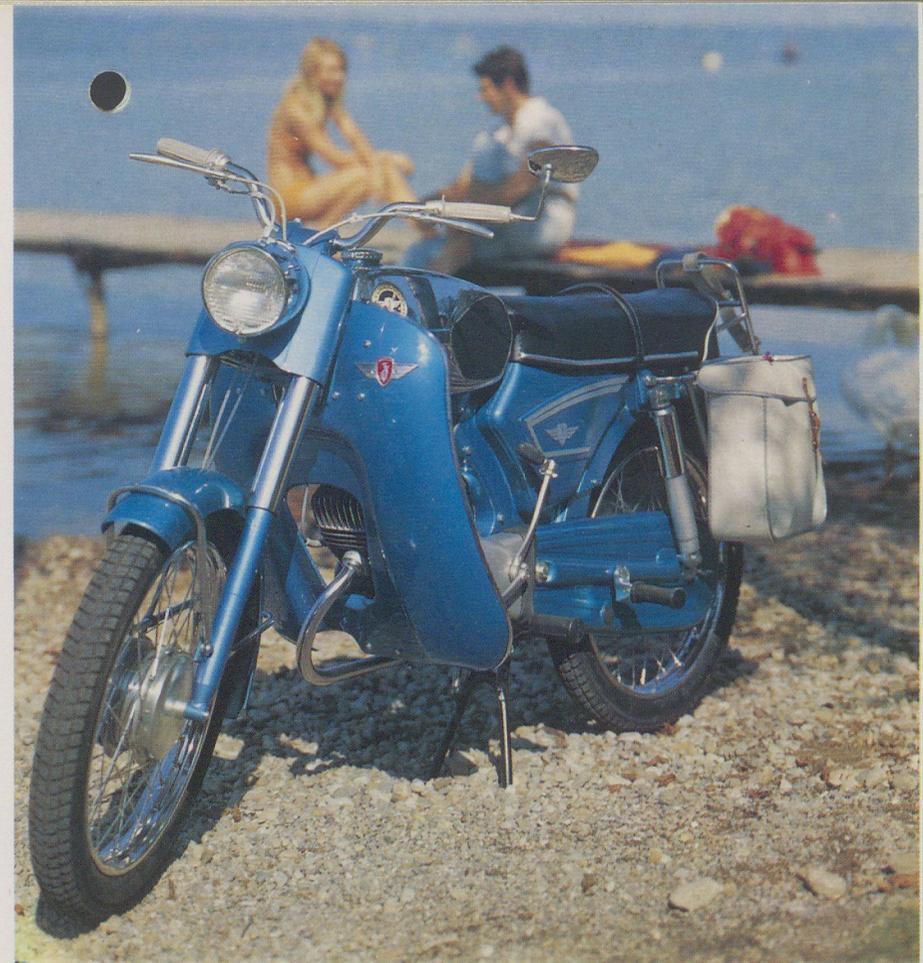
ZÜNDAPP baut als technische Besonderheit bei den 50-ccm-Serienmaschinen ein wartungsfreies Feinstfilter in den Druckgußrahmen ein. Die aus dem Raum unterhalb der Sitzbank angesaugte Luft gelangt über den großvolumigen Ansaugeräuschkämpfer und das Feinstfilter rein und sauber in den Vergaser. Das bedeutet für den Motor: gleichbleibende Leistung, längere Lebensdauer.
